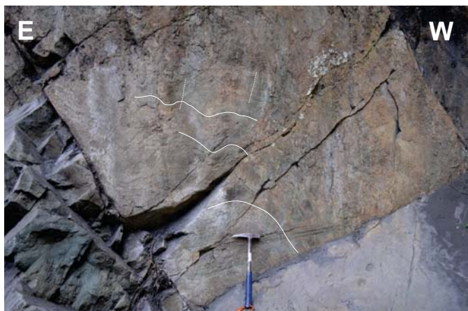
Figura 26. Esquistos verdes del Complejo Cajamarca. Nótese el plegamiento y el desarrollo de incipiente crenulación paralela a los planos axiales de los pliegues.
